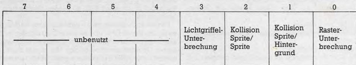
Bild 38. Das Interrupt-Enable-Register (53274 = \$d01h) des VIC-II-Chip
